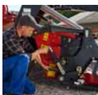
Prosta regulacja wysokości koszenia.
