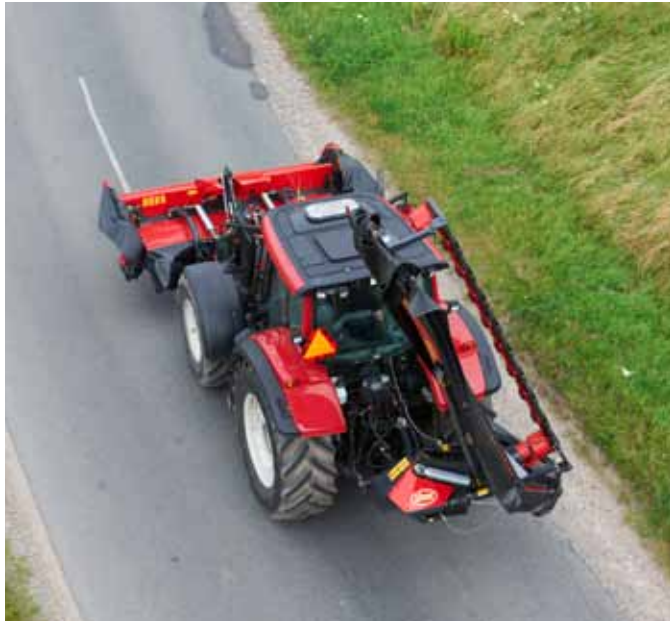
Pozycja transportowa pod kątem 125° zapewnia optymalne rozłożenie wagi.
