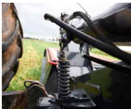
Kiedy najeżdżamy na przeszkodę zabezpieczenie najazdowe Non-Stop odchyła listwę do tyłu oraz w górę.
